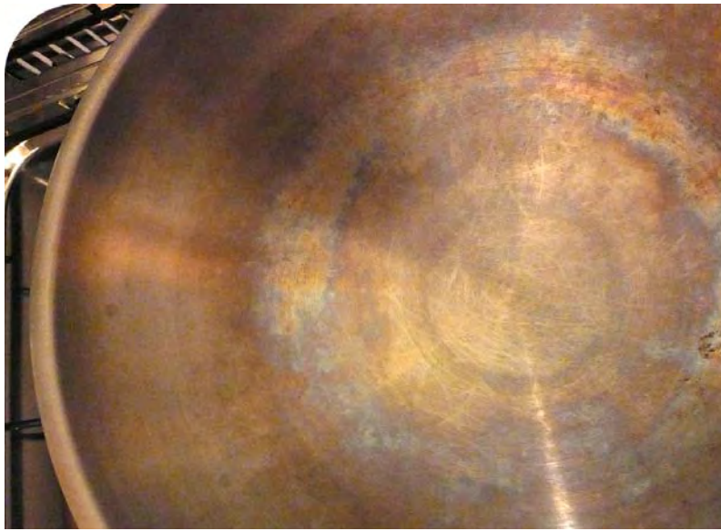
Angelaufener Edelstahl Wok. Auffallend die zentrale Aussparung aufgrund der ringförmigen (und nicht zentral und punktförmigen) Hitzeinwirkung durch einen 3kW ‚Single-Ring-Burner‘.
