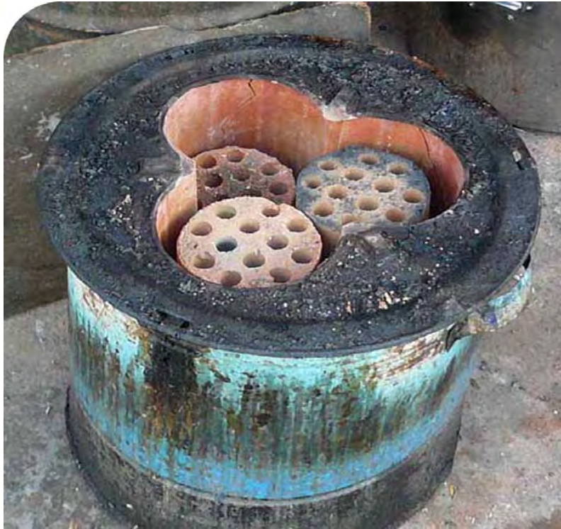
Traditioneller Ofen für die Wok Erwärmung mit 3 Röhren für Brennelemente aus formgepresster Steinkohle, die hier zum Teil noch mit abgebrannter, geformter Asche gefüllt sind. Deutlich sichtbar die 3 Auflagestellen für den Wok (Jeweils am Schnittpunkt der Röhren). Shanghai, China 2007.
