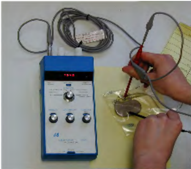
Abbildung 3.4: Medtronic Herzschrittmarker-Tester. Gemessen werden können die Impuls-Amplitude, das Impuls-Intervall und die Impuls-Breite.
