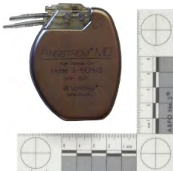
Abbildung 6.1: Explantierter Ventritex Angstrom MD Model V-190HV3 ICD Generator, telemetrisch deaktiviert.
