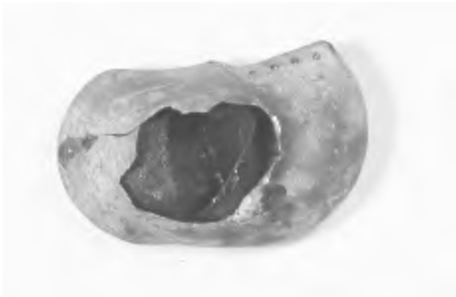
Abbildung 2.11: Ein durch thermische Einwirkung (Kremierung) explodierter Herzschrittmacher. Deutlich zu erkennen ist die Aufbördelung des Generatorgehäuses aus Titan und die entsprechende Aufbördelung des darin befindlichen Batteriegehäuses (ebenfalls aus Titan).
