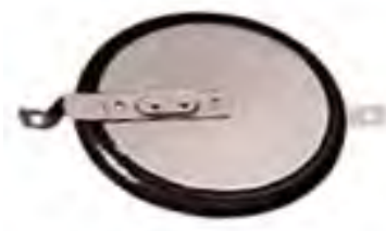
Abbildung 5.4: Wiederaufladbare Lithumbatterie VL3032 von Panasonic. [54].
